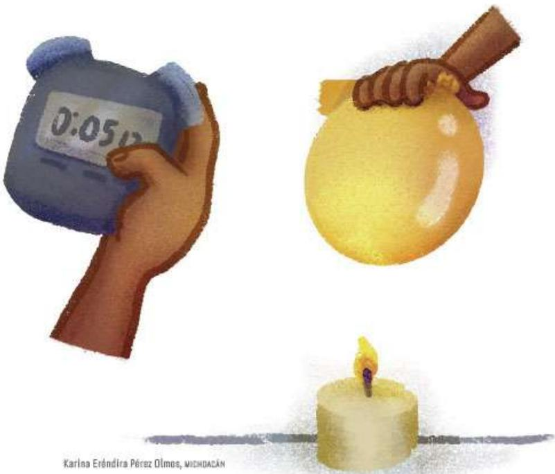
Gracias a la capacidad calorífica que tiene el agua, ésta logra absorber el calor que se transfiere al estar en contacto con las paredes del globo evitando así que explote.
